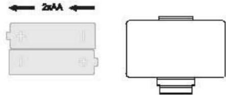
1. Retire la tapa del compartimento de baterías, localizado en la parte trasera del display
