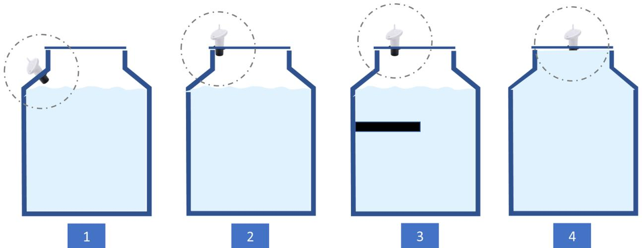
Instale el transmisor en su tinaco o depósito de agua adecuadamente para que las lecturas que el display le muestre sean correctas y correspondan a las dimensiones de su tinaco. Se ejemplifican 4 escenarios en los cuales el transmisor ha quedado mal colocado, y se explica a continuación la razón:
